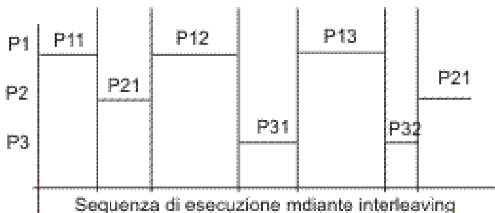
Figura 2.1 Sequenza di esecuzione per una CPU
